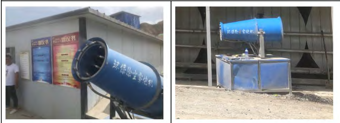
施工场地配备环保除尘雾炮机
