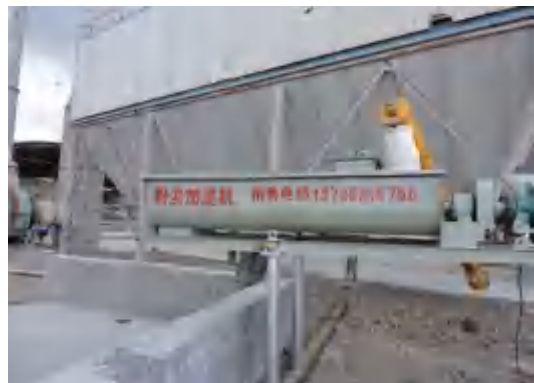
施工1标、施工2标沥青拌合站的粉尘加湿机
