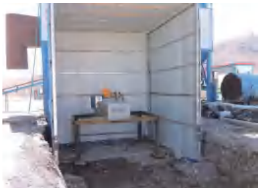
施工1标、施工2标沥青拌合站的粉尘加湿机
